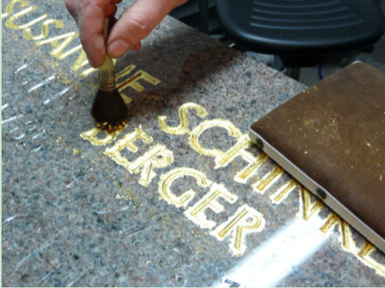
Abb. 62: Aufbringen des Blattgoldes mit Spezialkleber
