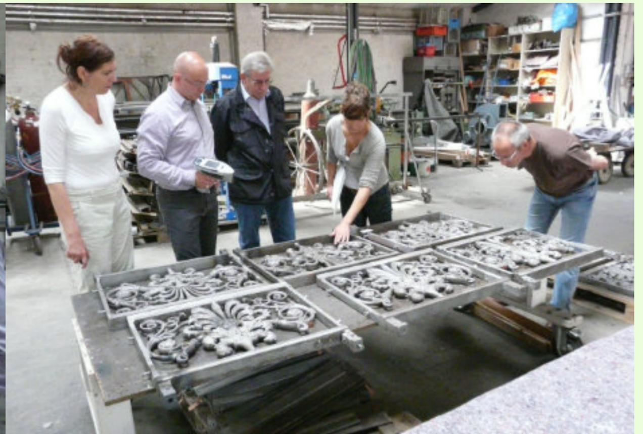
Abb. 24: Werkstattbesuch 27.07.2011 Sichtung der von Farbschichten gesäuberten Gitterteile
