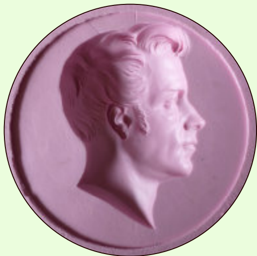
Abb. 48: Negativabguß vom Original aus Silikon. Das ausgehärtete Silikon wird mehrschichtig mit flüssigem Spezialwachs gestrichen bis die erforderliche Materialdicke der Bronze erreicht ist.
