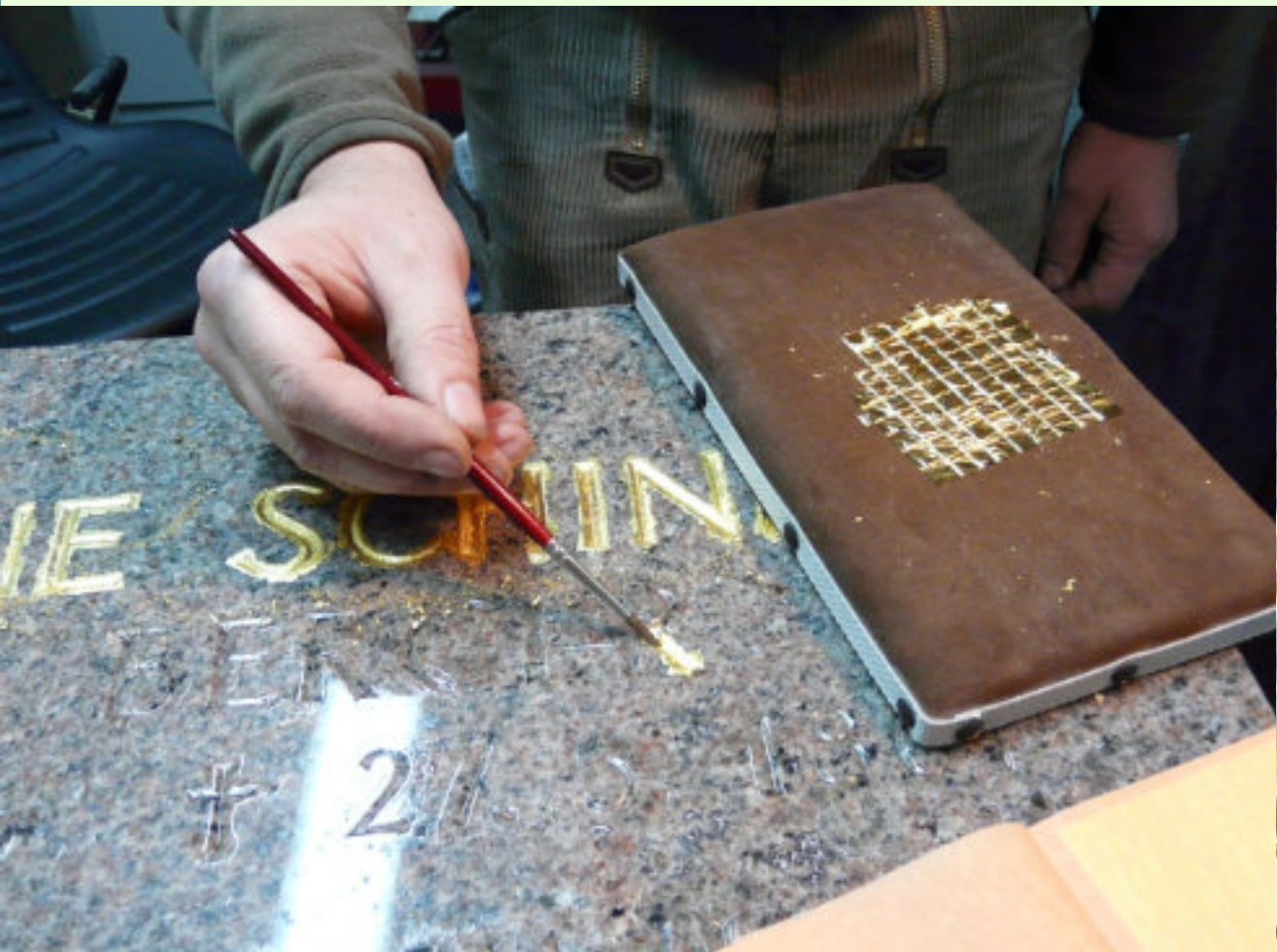
Abb. 62: Aufbringen des Blattgoldes mit Spezialkleber
