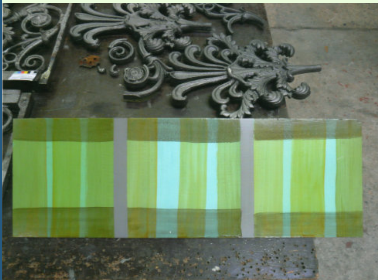
Abb. 30: Farbmusterabstimmung mit verschiedenen Lasur-Mustervorlagen nach Altbefund und Zuordnung zu NCS 4020 G 50 Y mit Diskussionen
