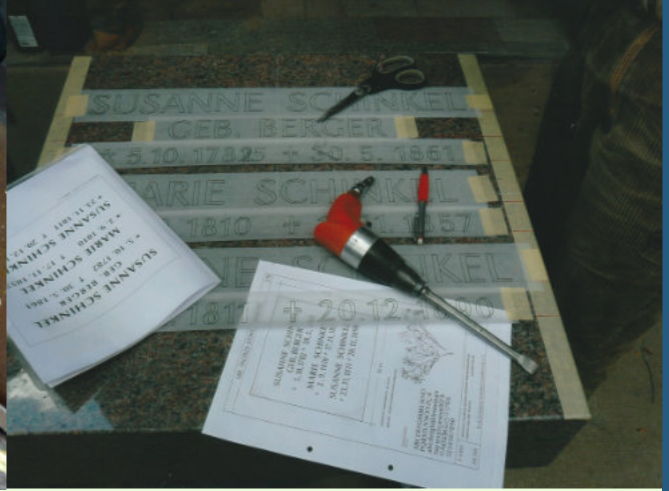
Abb. 63: Übertragung der Schrift mit Anriß auf den polierten Liegestein mit Pressluftmeissel
